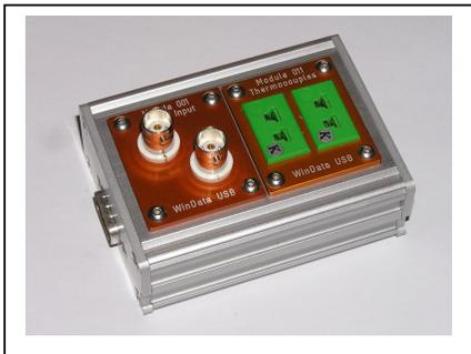
Supporta i moduli specializzati per tipologia di segnali, converte i segnali analogici in digitale, memorizza permanentemente tutte le calibrazioni e le configurazioni
